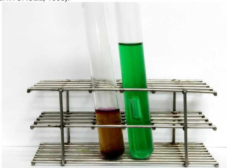
Figura1. Tubo com caldo triptona à esquerda apresentando anel vermelho indicando a presença de coliforme termotolerante a partir da presença gás no tubo à direita com Brilliant Green Bile Broth 2%.
